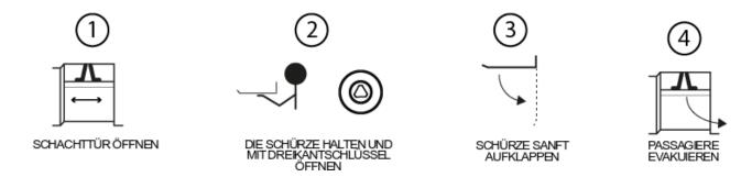
Stellen Sie nach der Rettungsaktion sicher, dass die Schachttüren ordnungsgemäß geschlossen sind.
